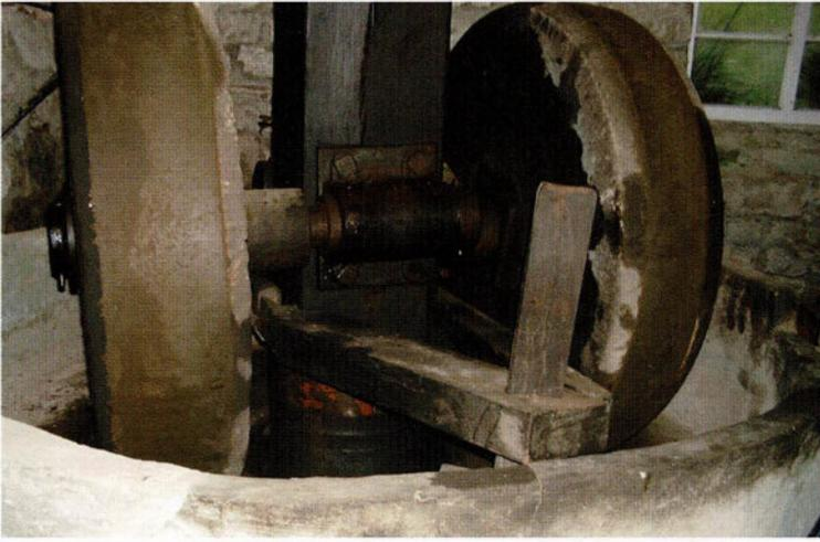
Die alte Technik mit zwei ober-schlächtigen Wasserrädern als Antriebskraft ist nun schon über 300 Jahre alt. Sie war so grundsolide, dass sie nicht nur bis heute intakt ist, sondern auch nie durch andere Antriebsenergie (Elektromotoren) ersetzt wurde! Die letzte große Veränderung fand 1870 statt, als eine Rundsiebanlage die bis dahin übliche Handschöpferei des Papiers mechanisierte.
