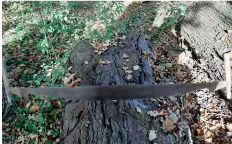
Einen so dicken Stamm mit der Schrotsäge zu durchtrennen, dauerte ein bis zwei Stunden. Die Säge wurde von zwei Arbeitskräften geführt.
