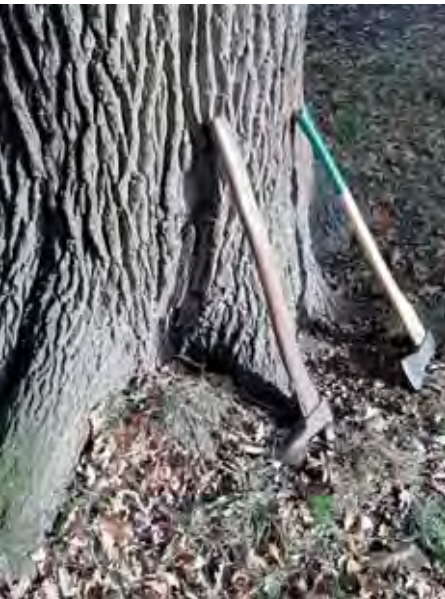
Mit Axt und Hacke wurden die Wurzeln in Abschnitten von fünf bis zehn cm des zu fallenden Baumes abgetrennt. Das ergab eine ganze Menge an „Wottelspöne“ als Brennmaterial. Eine so dicke Eiche zu fällen, dauerte einen ganzen Arbeitstag
