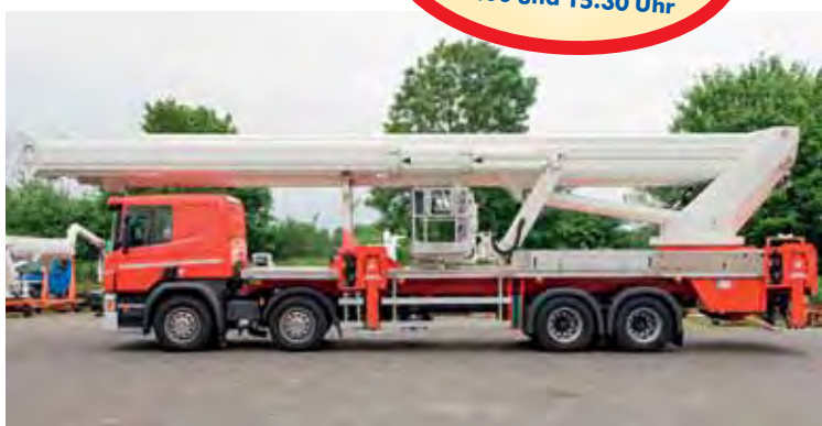
Die Plattform des Hubsteigers kann auf über 70 Meter ausgefahren werden
